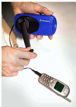
Chargeur à manivelle Freepaly 45 secondes de remontage donnent 3 à 6 min d'appel
